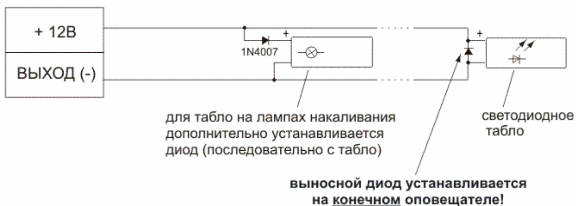
Рис. 6.1. Схема подключения нескольких световых табло
